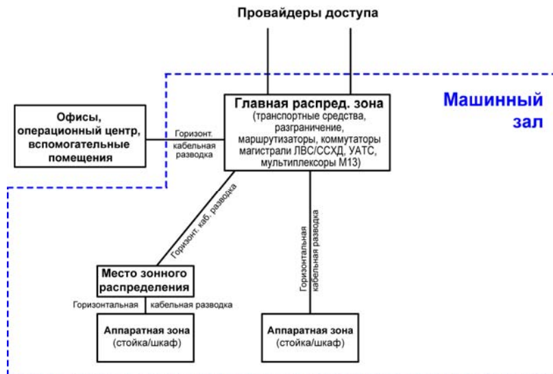
Рис. 4. Пример редуцированной топологии дата-центра
