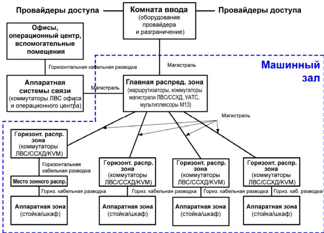
Рис. 3. Пример базовой топологии дата-центра
